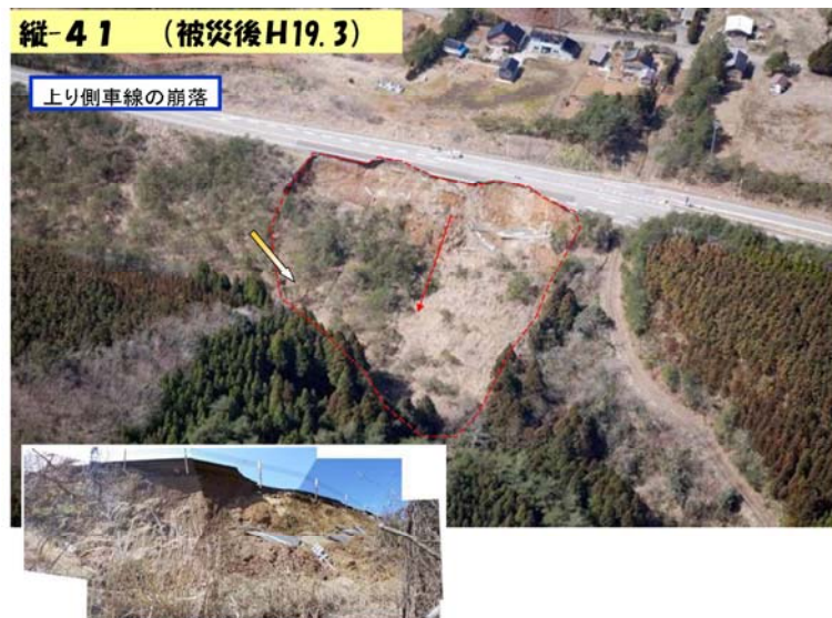
写真-3.1.1(j) 能登有料道路地震被害状況写真 (22.2kp、縦-41)
