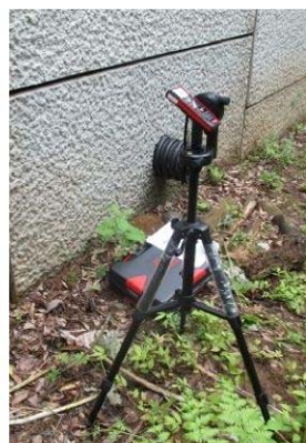
図-7.1.4 レーザー距離計を用いた擁壁の傾斜・はらみ出しの計測例
