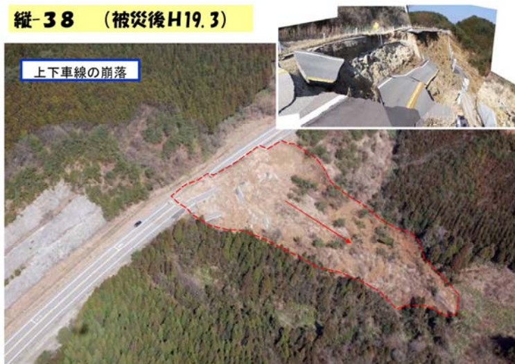
写真-3.1.1(h) 能登有料道路地震被害状況写真 (21.1kp、縦-38)
