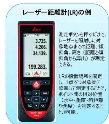
図-7.1.4 レーザー距離計を用いた擁壁の傾斜・はらみ出しの計測例
