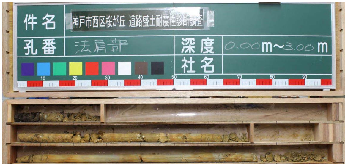
写真-3.4.6 バイブロハンマーによる簡易サンプリング実施状況
