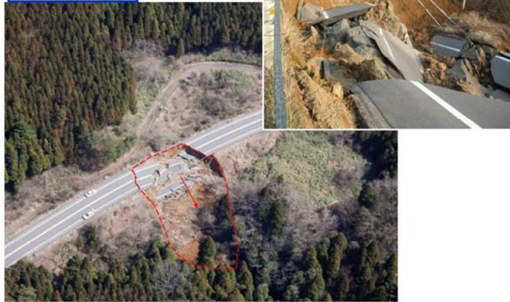
写真-3.1.1(d) 能登有料道路地震被害状況写真 (11.7kp、縦-14)
