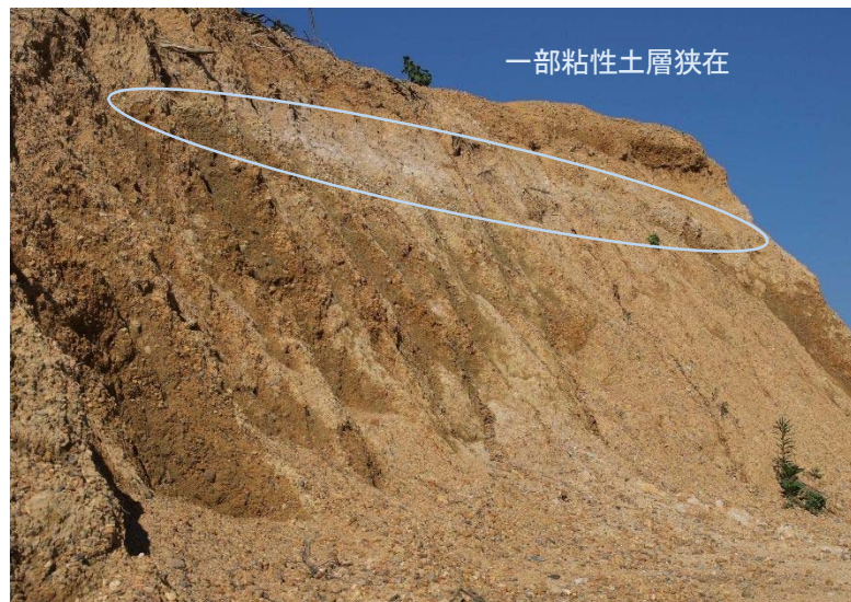
写真-3.4.2 近傍土取場の状況（礫混り細粒分質砂が主体）
