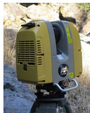
図-4.4.1 レーザスキャナー（TOPCON GLS-2000）
