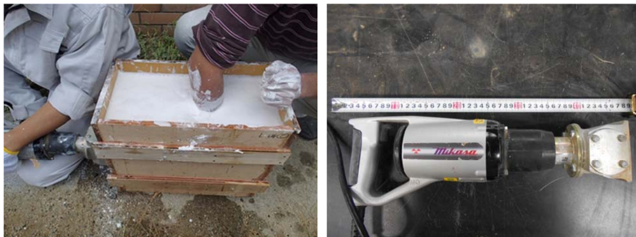
図 4-7 模擬剛体作成時の攪拌状況
