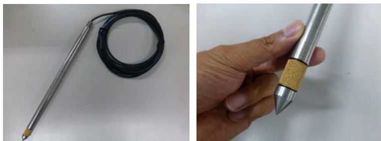
写真-3. 2. 5 小型間隙水圧計の仕様
