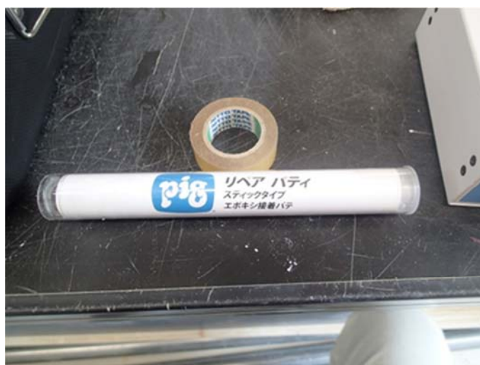
図 4-12 模擬剛体との接着に用いたエポキシ樹脂製パテ
