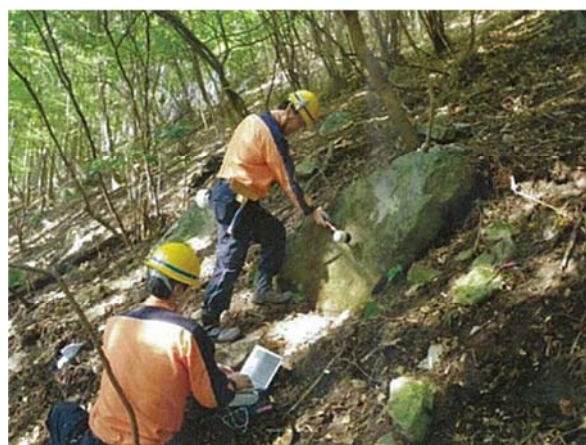
図 4-2 斜面における転石の振動計測状況
