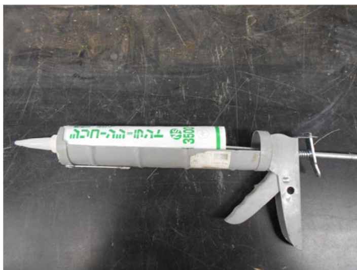
図 4-6 シリコン製シール材（充填材）
